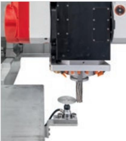
Master puede equiparse con el aparato de preajuste mecánico que, con la máxima rapidez y facilidad, permite medir siempre las herramientas de forma exacta y actualizada durante los procesos de mecanizado, evitando cualquier tipo de error de parte del operador.
